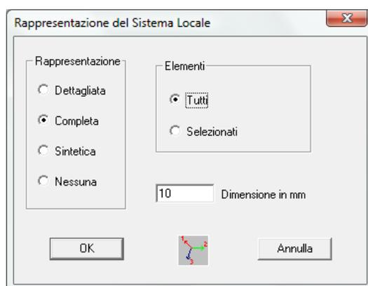
In questo modo, su tutti gli elementi viene rappresentata la terna completa degli assi di riferimento del sistema locale. L'asse 1 è quello lungo l'asse dell'elemento, gli assi 2 e 3 sono nel piano della sezione. Nell'immagine seguente vediamo in dettaglio l'orientazione dell'elemento orizzontale, che è quello che ci interessa.
